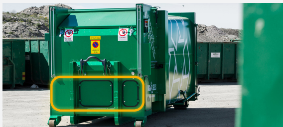
I inspeksjonslukene får du tilgang til stempelkammer.
